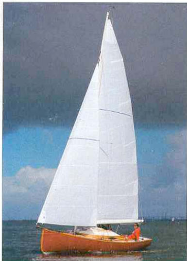
Le gréement fractionné aux trois quarts profite d'un grand foc grâce à un petit bout-dehors qui surplombe l'étrave canoë.
